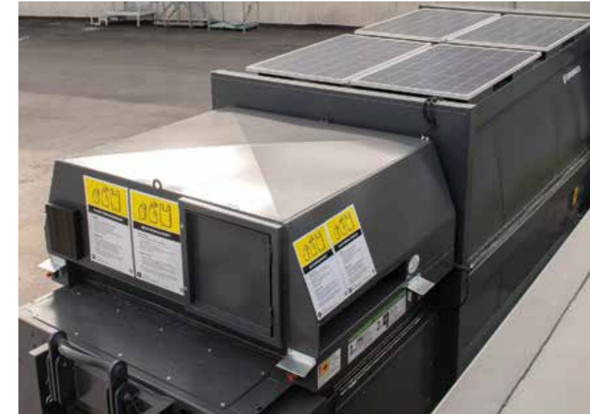
Rinki Ekopisteessä, Riihimäellä on pakkausmuovin keräykseen tarkoitettu Europressin aurinkoenergiaa hyödyntävä CombiMax SMART Solar -jätipuristin.
